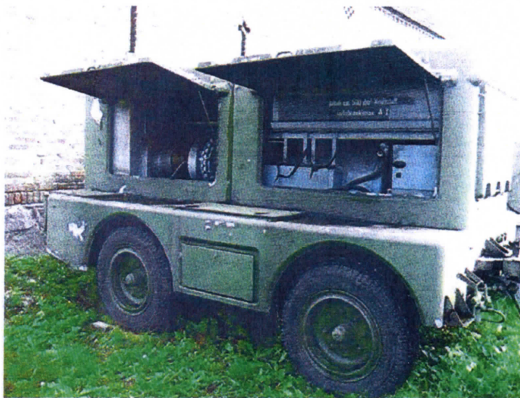
Stromerzeuger 160kVA in der grünen Farbgebung für die NVA
